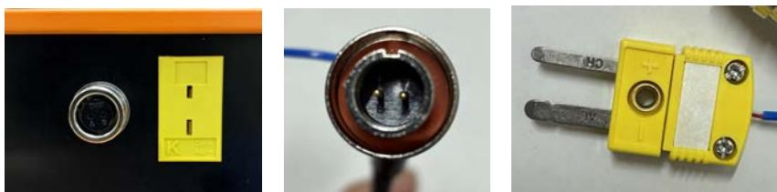
マットコネクタを差し込む際は、嵌合面の向きに気を付けながら、プラグの奥までまっすぐ差し込み、ネジを回してケーブルが抜けないようにしてください。温度センサーは挿し口が細い側 (+) が上になるよう確認して取り付けてください。
