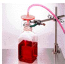
ニューステラディスク50は500mL～10Lの培養液をろ過滅菌するために開発されたディスポーザブルフィルターです。
