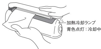
加熱冷却ランプの青色が消灯し、ピッとブザーが鳴ると冷却終了です。圧着レバーを上げてください。
